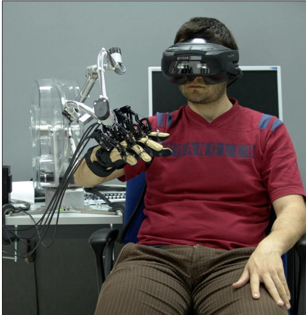
Fig. 4 L'interazione aptica nell'applicazione di manutenzione proposta usando il sistema a ritorno di forze CyberForce
