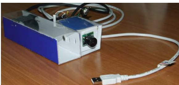
Fig. 4 – Student Presence Detector per la rilevazione dello studente. Il sistema si compone di un misuratore di distanza, un blocco di lettura della qualità dell'aria e di un meccanismo di gestione della ventilazione.
